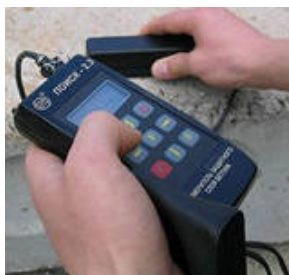
Рис. 2.21. Определение диаметра арматуры в железобетонной конструкции
