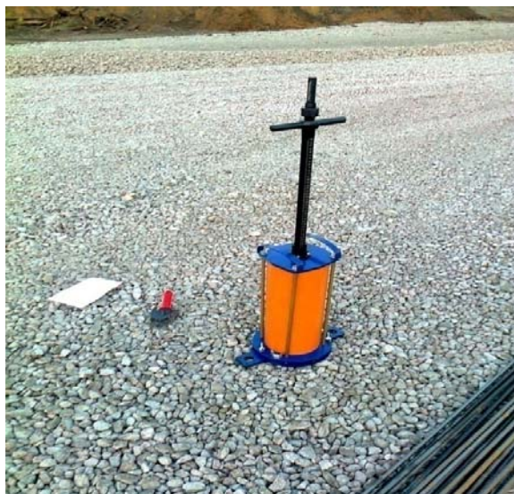
Рис. 2.25. Определение плотности основания из щебня
