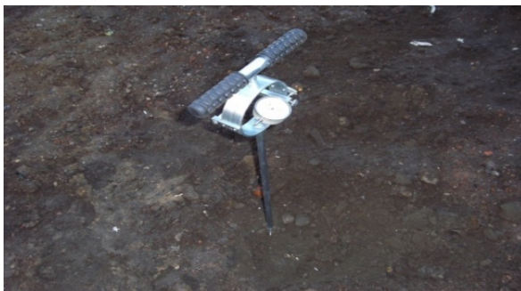
Рис. 2.24. Определение плотности основания из песка
