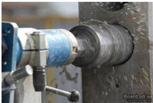
Рис. 2.17. Высверливание образцов кернов бетона для испытания на прочность в лаборатории
